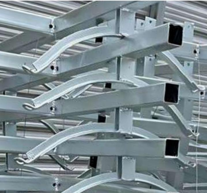
**1.** Cada orificio de ventilación debe estar lo más cerca posible de la soldadura con el borde del orificio a menos de 1/2 pulgada [12 mm] del borde del cordón de soldadura, y no menos de 3/8 de pulgada [9,5 mm] de diámetro. Los dos agujeros en cada intersección deben estar separados 180 ° y en la ubicación adecuada como se muestra.
