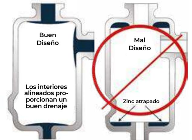
Ilustración 50 Ventilación apropiada e inapropiada
