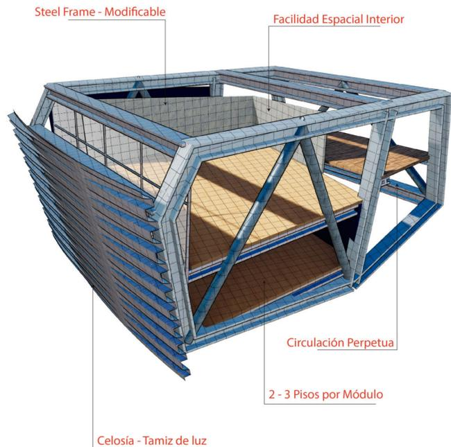
En la parte constructiva se ha pensado en desarrollar módulos que son prefabricados en taller, e instalados en obra. El sistema de pisos así como acabados e instalaciones eléctricas e hidrosanitarias serán completadas una vez instalada la estructura principal.
