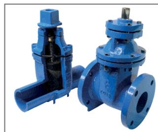
Válvulas: hierro fundido norma ASTM 126 clase b, o en hierro dúctil norma ASTM 536 grado 65-45-12. Los demas materiales norma internacional AWWA c-500.
