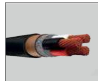
Conductor de cobre extraflexibles para 300V. aislamiento y chaqueta externa de caucho termoplástico (TPE), resistente al agua y aceites y aprobados para usarlos exteriormente.
