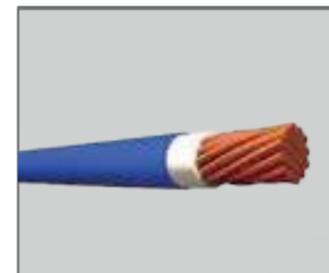
Conductor de cobre para 600 V. aislado con policloruro de vinilo (PVC) 90°C, y chaqueta de poliamida (nylon), resistente a la humedad, calor elevado, aceite y gasolina.
