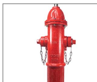
Hidrantes: fabricados bajo la norma internacional AWWA c-502, pueden ser fabricados en hierro fundido según la norma ASTM 126 clase b o en hierro dúctil según la norma ASTM 536 grado 65-45-42
